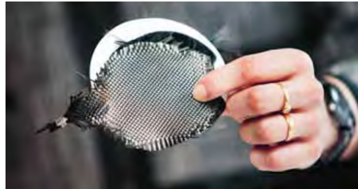
Algebatteriet består af tre komponenter. Papirtynde kulstofelektroder, det opladelige algepapir og et almindeligt filterpapir, mættet med kogsalt.
